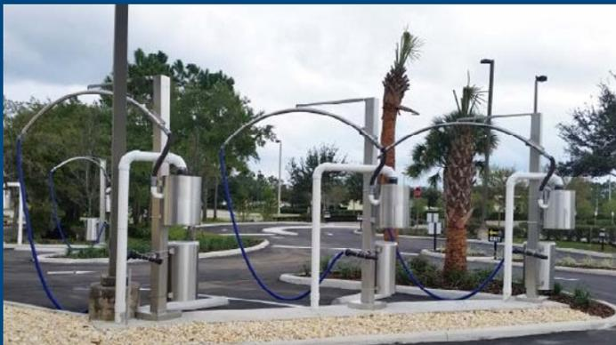
Proporcione fácilmente varias estaciones de aspirado con un sistema central con el nuevo Sistema de Aspirado Coleman Hanna. Este sistema de aspirado central proporciona facilidad de uso con una sola ubicación central para el servicio. El sistema de aspirado central es ideal para ubicaciones con aspiradoras gratuitas, como túneles de servicio completo y exprés.
